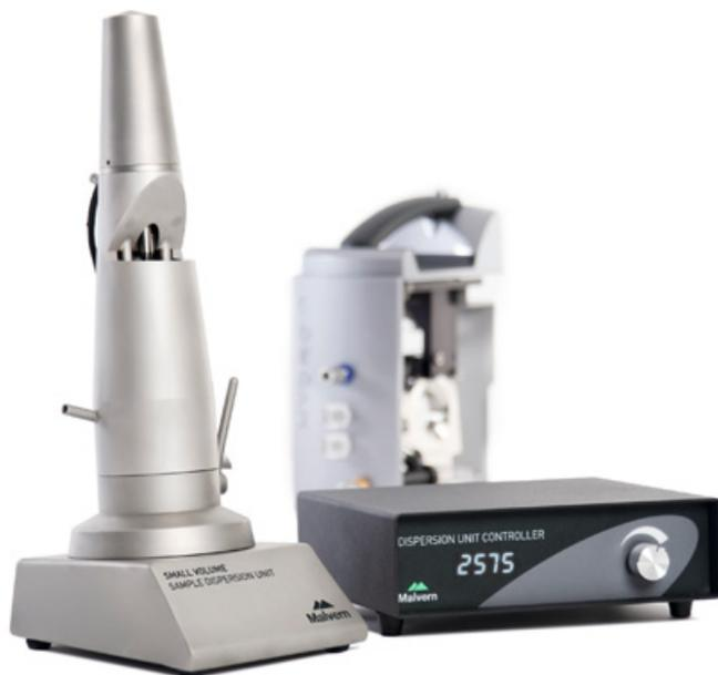
L'Hydro SM est un accessoire économique de dispersion d'échantillons en voie liquide, conçu pour mesurer des échantillons dans des dispersants non aqueux où l'utilisation de solvants doit être réduite au minimum.
