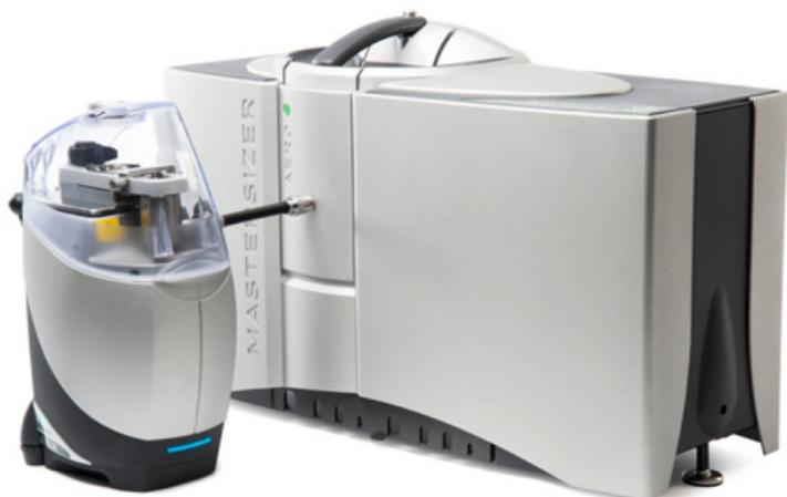
L'Aero M est un chargeur de poudre sèche d'entrée de gamme pour le Mastersizer 3000E, permettant la mesure de distributions de tailles des particules sur des échantillons de poudres sèches. Sa conception permet des mesures fiables de taille de particules pour les applications industrielles mais aussi des maintenances facilitées lors d'une utilisation habituelle.
